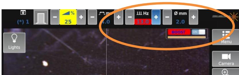
La funzione boost permette di aumentare le prestazioni del laser per un certo periodo di tempo, la potenza media / frequenza di sparo può superare del 20 % il limite massimo.
