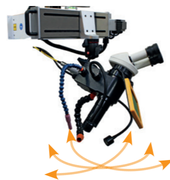
Welding head tilt in all directions Testa di saldatura tiltante in tutte le direzioni
